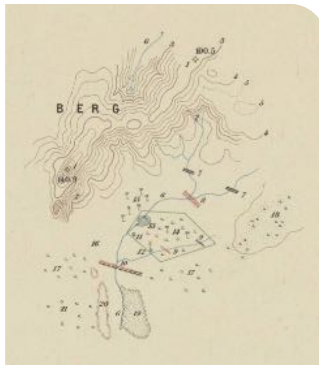
5.7 Legenda van de Werbata-Jonckheer kaarten van Bonaire (1911-1915). De waterstructuren zijn hierop duidelijk aangegeven zoals: “6 Droge bedding der in den regentijd gevormde beken (Rooi)”, “7 Aarden dammen”, “8 Steenen dam” en “13 Tanki, gegraven reservoir van regenwater”.
