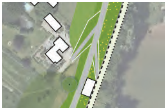
Fig 4.7 - Aanhechten nieuwe steunberm in vloeiende lijn.
