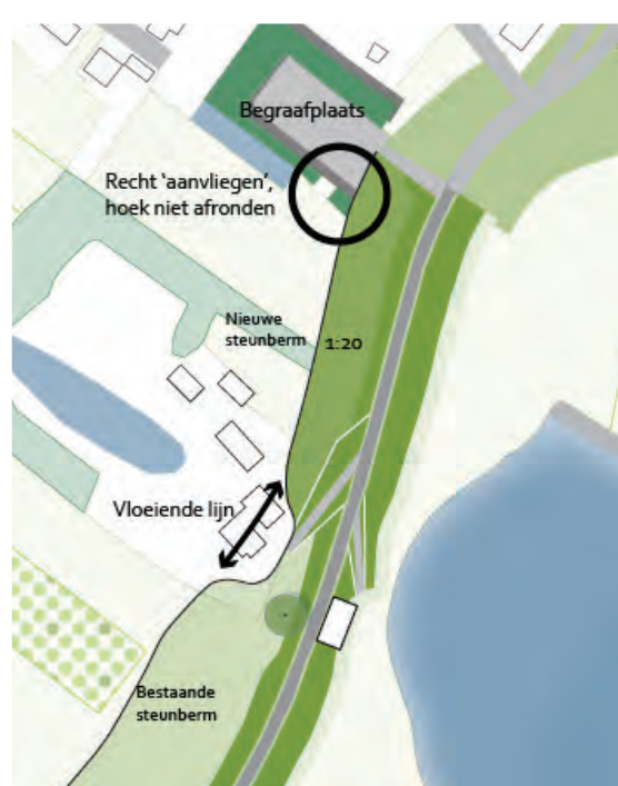
Fig 4.7 - Aanhechten nieuwe steunberm in vloeiende lijn.
