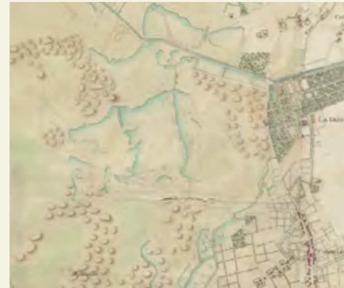
Afb. 2.27. Stappersven op een 18 de eeuwse kaart. Veel vennen zijn met gegraven waterloopjes met elkaar verbonden, om turf te kunnen vervoeren of om de vennen sneller te ontwateren. Tegenwoordig proberen we het water juist minder snel af te voeren, om regenwater de kans te geven te infiltreren in de bodem en verdroging tegen te gaan.
