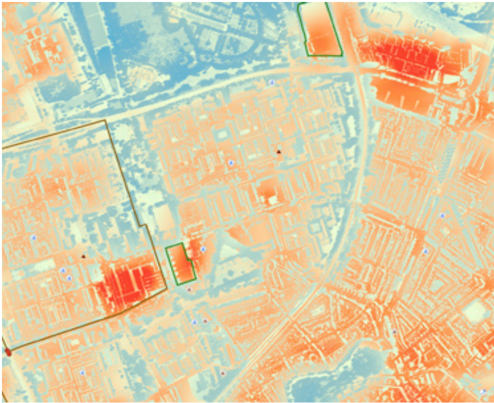
In de hittestresskaart valt op dat alle bebouwing in de wijk veel hitte vasthoudt, waarvan vooral de winkelcentra en sportvelden (de donker rode vlekken), en dat al het groen de koelere plekken zijn (de blauwe vlekken).
