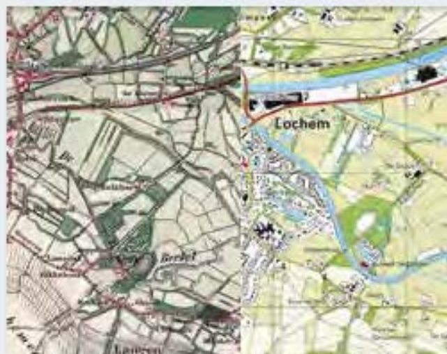
Het straktrekken van beken en het inrichten van het landschap met de focus op drainage heeft grote invloed gehad op de werking van het watersysteem, wat nu soms tot problemen leidt (beeld: Berkel bij Lochem in 1900 en 2024).
